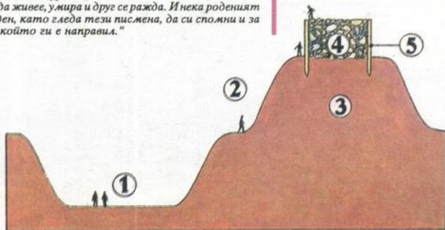
1 - ров (дълбок 6 м); 2 - хоризонтална площадка (берма); 3 - насип (висок 6 м); палисада (висока 3 м); 4 - пълнеж от камъни и пръст; 5 - дървени колове
